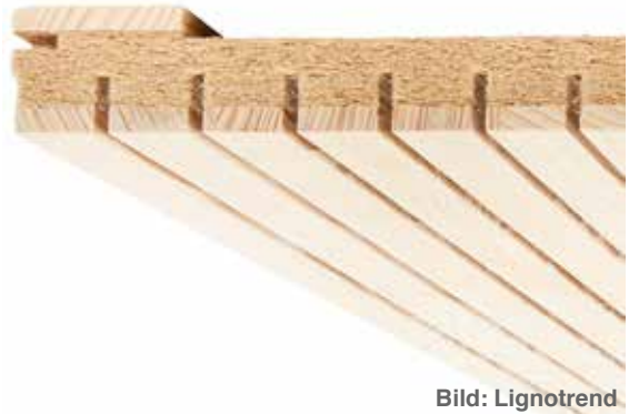
Abb. 22 Die raumseitige Brettlage wird mit Sägeschnitten genutet. Zwischen der dahinterliegenden Sparlattung ist Holzfaserdämmung zur Schallabsorption eingelegt. Dargestellt sind Bekleidungs-elemente zur nachträglichen Montage.
