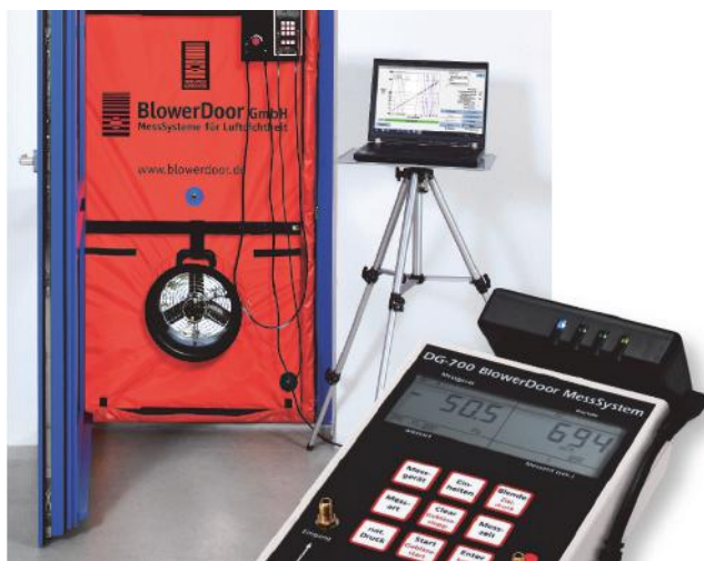
Abb. 6: Messzeitpunkt: Nach Fertigstellung des Gebäudes. Bild: BlowerDoor GmbH
